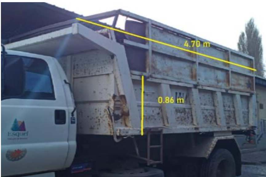
Altura de caja sin baranda 0.86 mts
